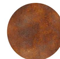
Pintura especial efeito aço corten, utilizado nos pilares metálicos do pavilhão.
