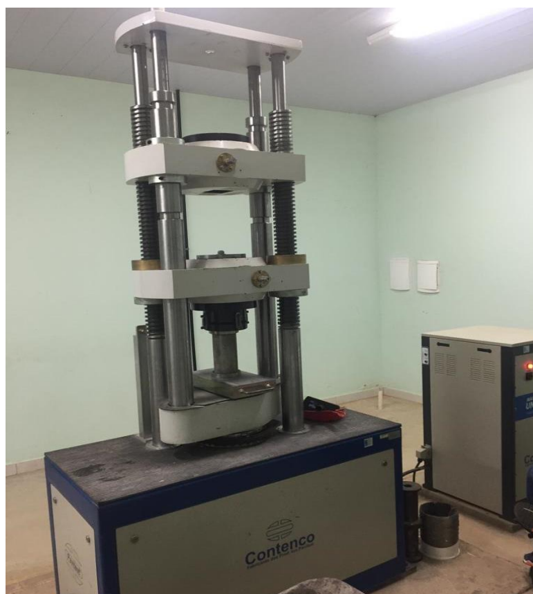
Figura 18: Realização do ensaio automático de resistência a compressão axial
