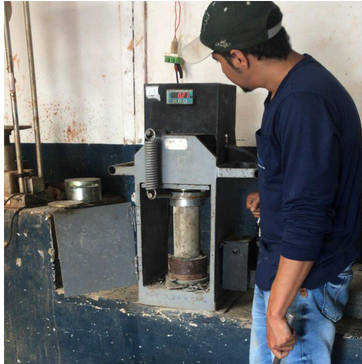
Figura 19: Realização do ensaio manual de resistência a compressão axial
