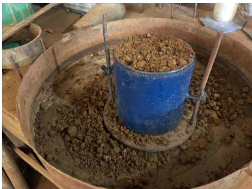
Figura 22- Compactação do corpo de prova de SMC
