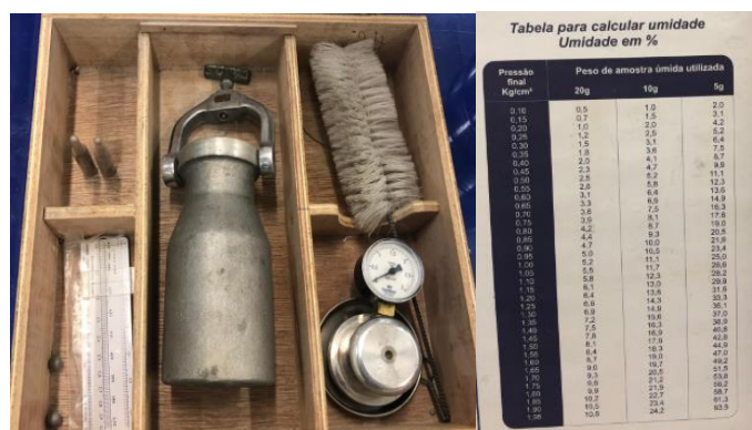
Figura 3 - (a) Conjunto speedy ; (b) tabela para calcular umidade em%
