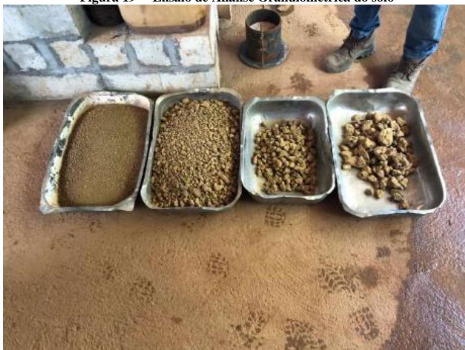
Figura 19 – Ensaio de Análise Granulométrica do solo
