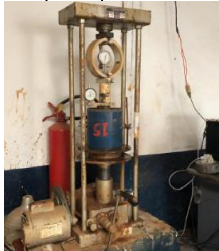
Figura 25 – Perfuração do corpo de prova na prensa de ISC
