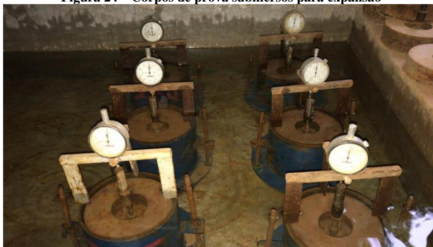
Figura 24 – Corpos de prova submersos para expansão
