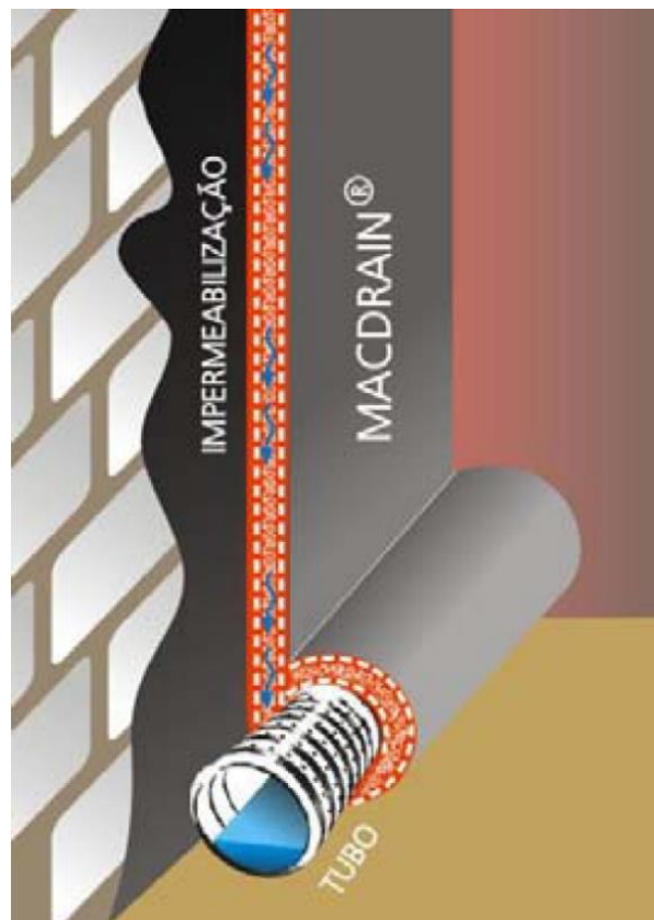
Figura 25 – Aplicação geocomposto MacDrain 2L
