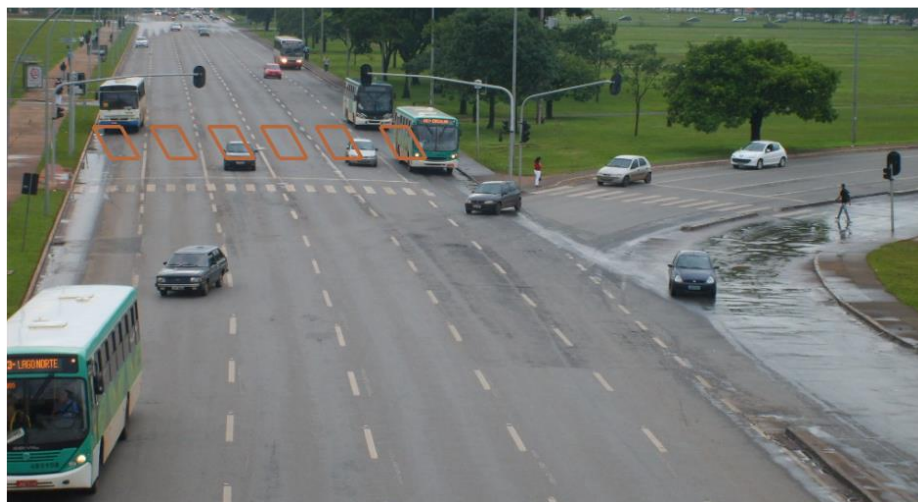
Figura 27 – Detecção de laços virtuais por tratamento de imagem
