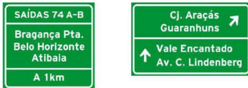
Figura 16 - Placa de pré-sinalização
