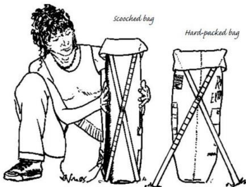
Figura 07 – Preenchimento das embalagens feito com adensamento de solo, para manutenção de suas dimensões.
