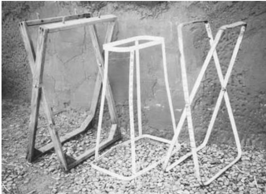
Figura 04 – Suporte de embalagens de polipropileno abertas e eretas para o preenchimento uniforme com a mistura conforme técnica do superadobe.
