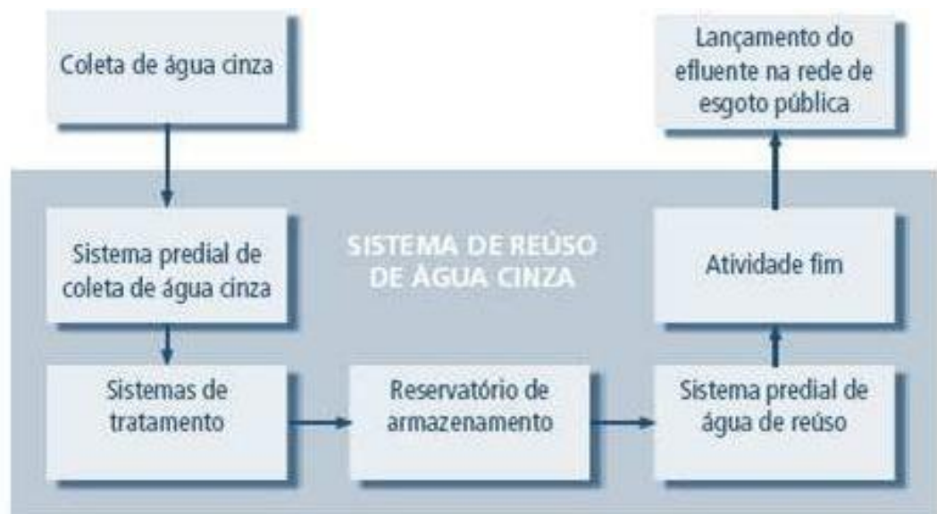
Figure 6 - Sistema de reuso de água cinza
