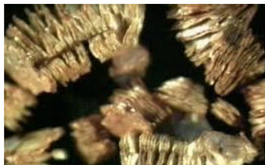
Outra característica da Vermiculita expandida é a baixa condutividade térmica, pois, após a expansão, o material apresenta alta porosidade, o que permite à vermiculita uma baixa condutividade, cerca de 0,06 kcal m/m<sup>2</sup>°C, a 25°C, o que permite sua utilização como isolante
