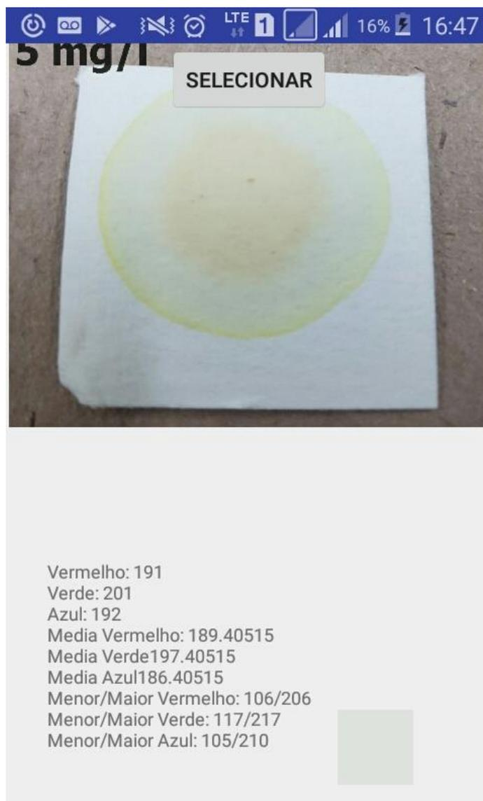
Figura 8 - Resultado da Amostra de 5mg/l
