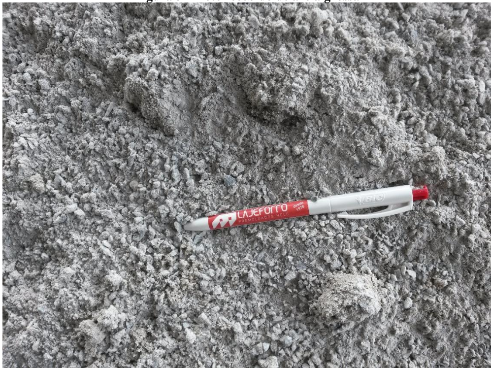
Figura 3 – Lote recebido de areia grossa
