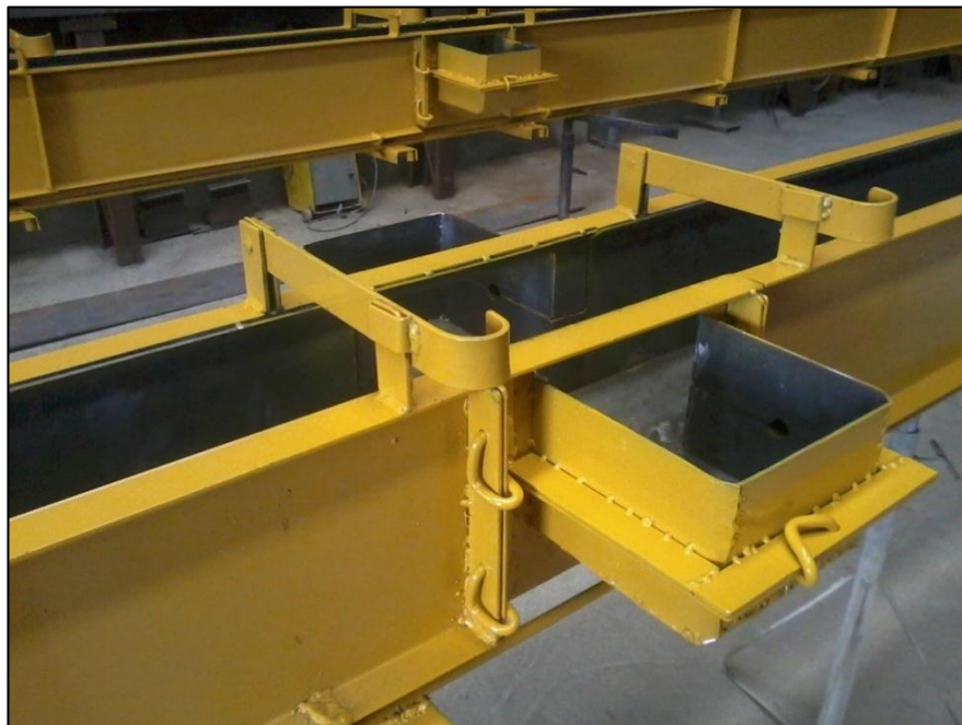
Figura 12 – Forma metálica de pilar pré-moldado.
