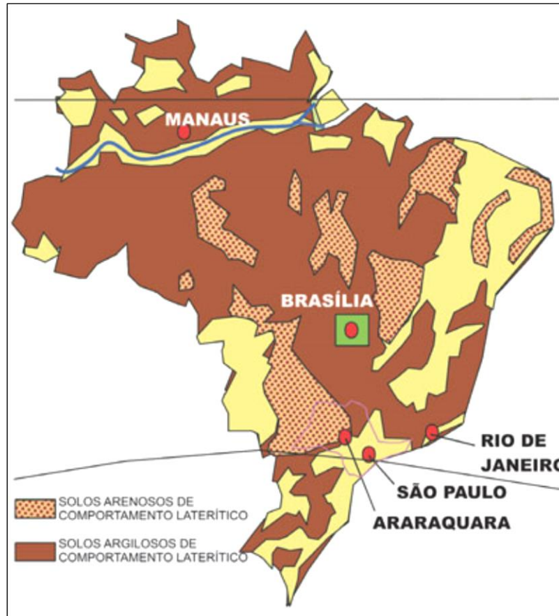
FIGURA 3 – Incidência de solos de comportamento laterítico no Brasil
