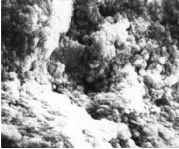
Figura 6 - Microfábrica do solo L, aumento 10.000X
