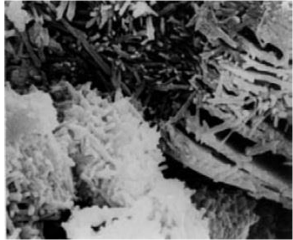
Figura 7 – Microfábrica do solo N, aumento 10.000X
