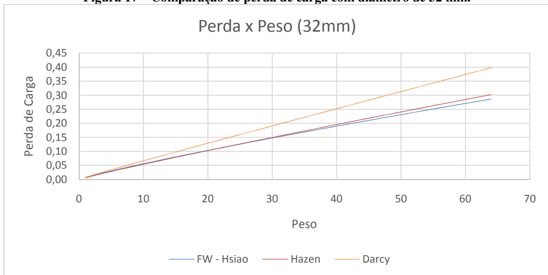
Figura 17 – Comparação de perda de carga com diâmetro de 32 mm.
