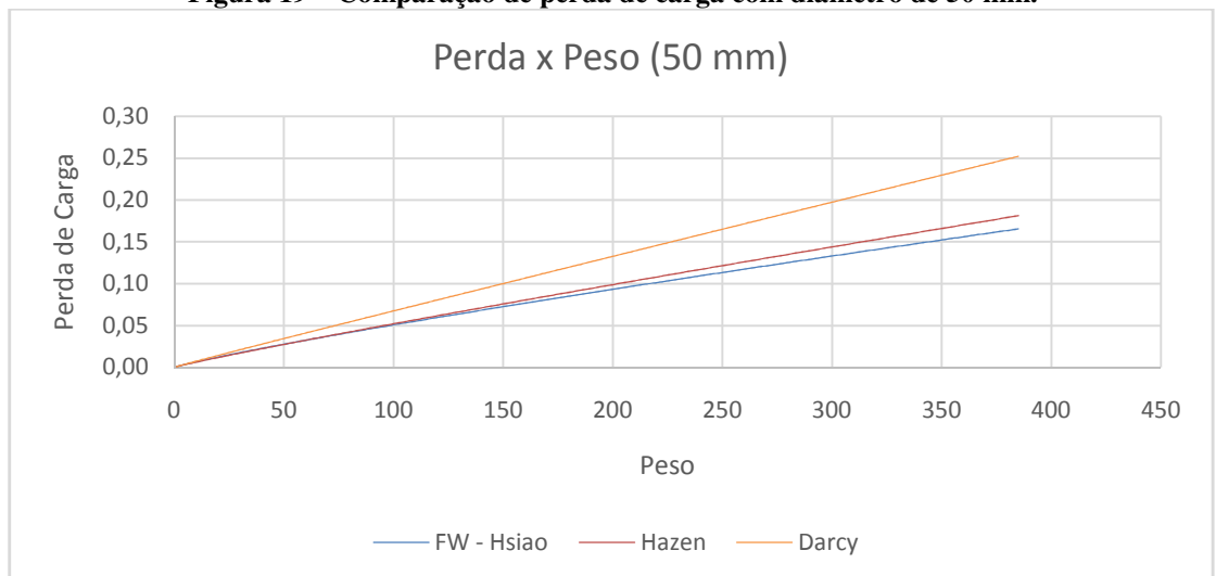
Figura 19 – Comparação de perda de carga com diâmetro de 50 mm.
