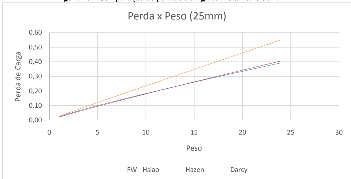
Figura 16 – Comparação de perda de carga com diâmetro de 25 mm.
