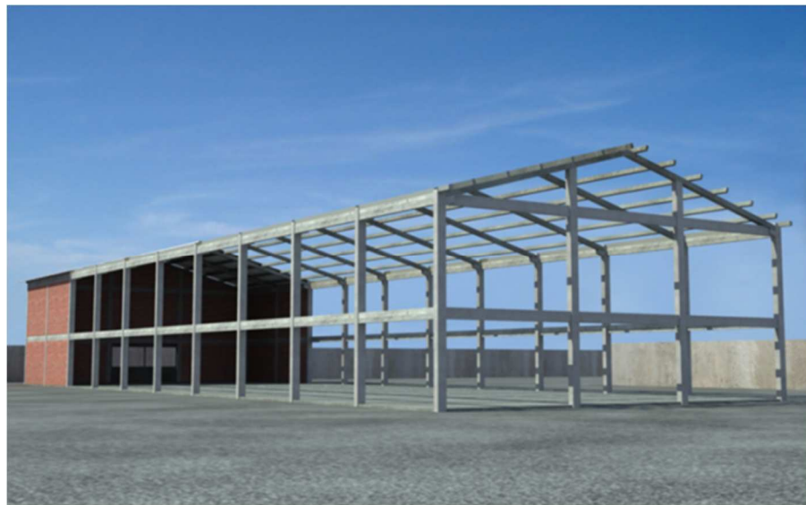
Figura 5-Sistema de estrutura aporticada
