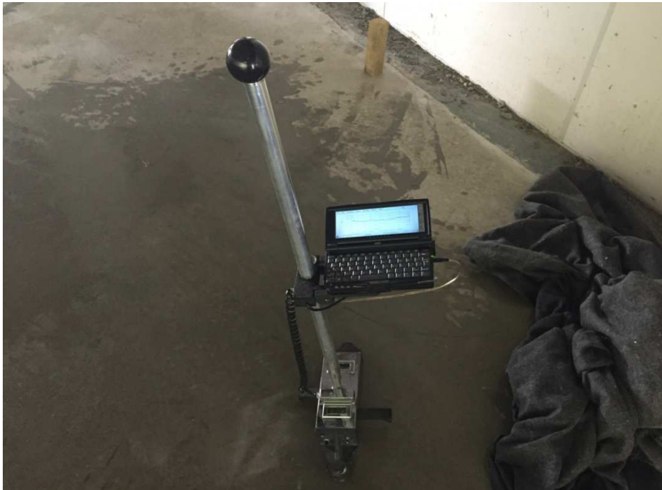
Figura 20-Medição através do processo F-Numbers
