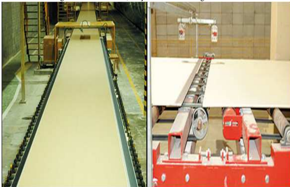
Figura 7: Alinhamento, reação natural de secagem e corte.
