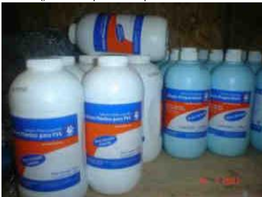
Figura 21 – Exemplo de adesivos para PVC com teor de VOC
