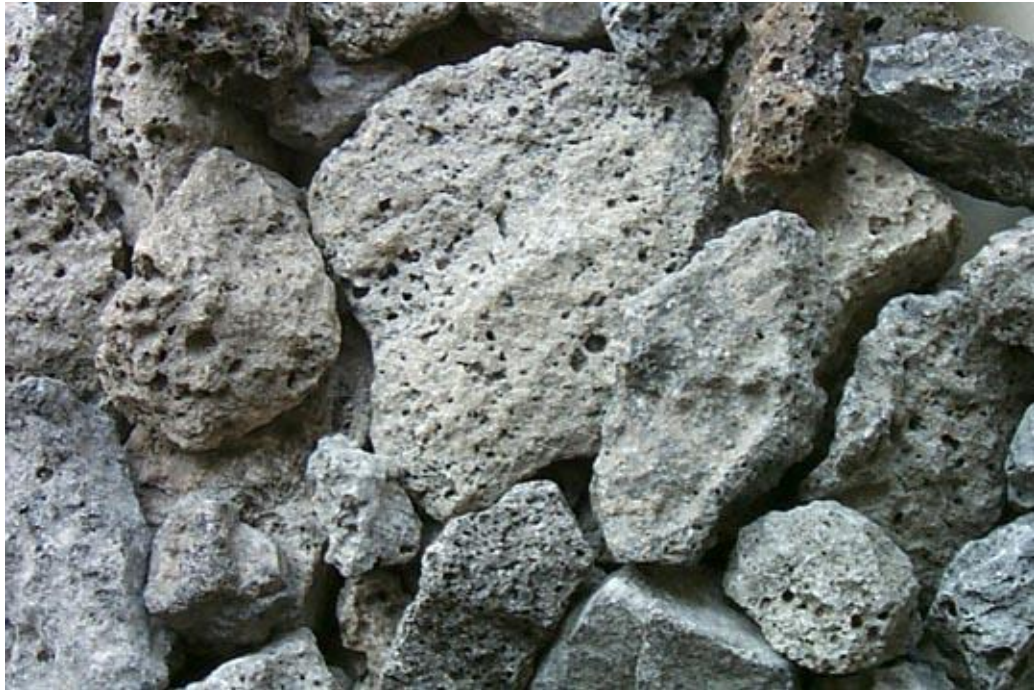
Figura 16 - Agregado gerado a partir de escória de alto forno.
