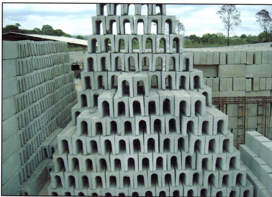
Blocos canaleta no pátio da fábrica de pré-moldados da Correia Engenharia. Foto: Kennedy da Silva Correia, 06/11/2007.
