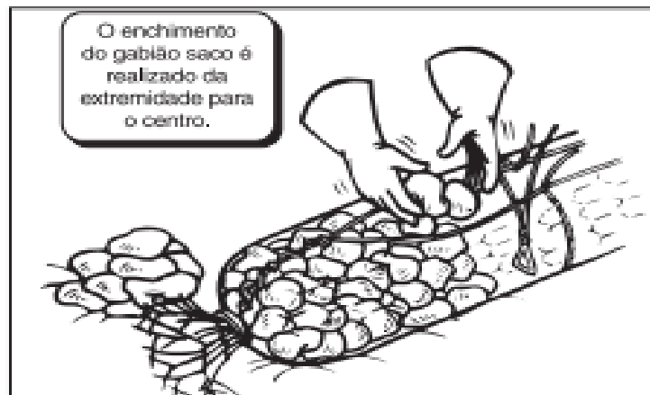
Figura 23 - Detalhe de enchimento gabião tipo saco.
