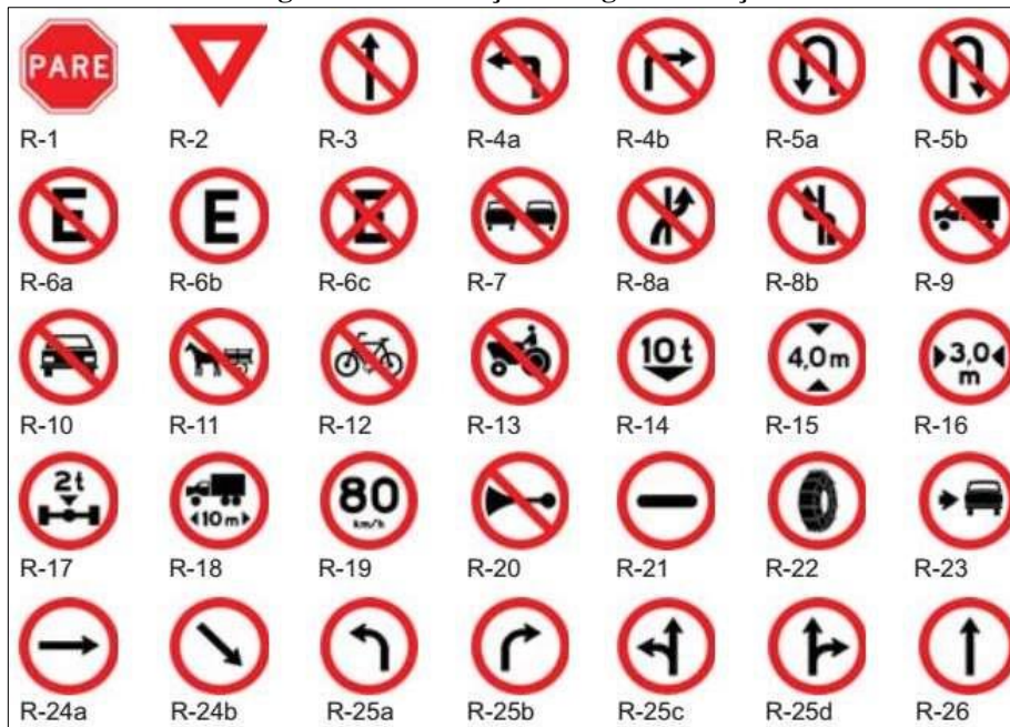
Figura 3 – Sinalização de regulamentação
