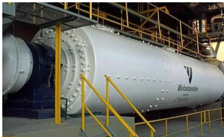
Figura 6 – Moinho de Cimento
