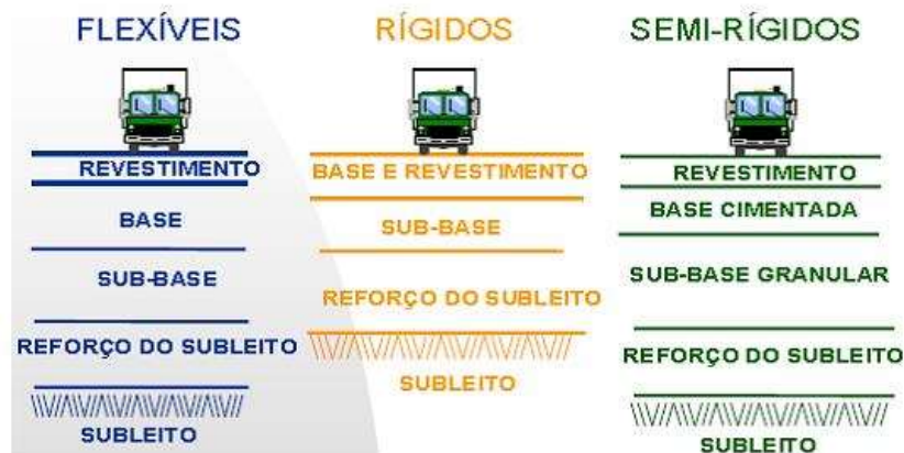
Figura 09 - Comparação entre as estruturas dos pavimentos flexíveis, rígidos e semi-rígidos.
