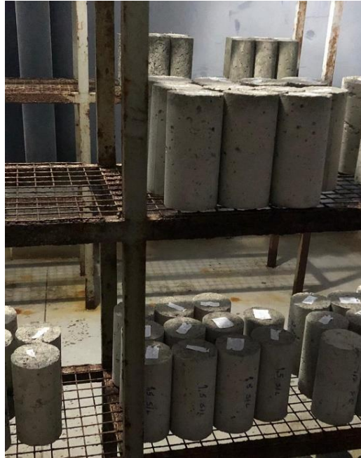
Figura 9 – Corpos de prova na câmara úmida
