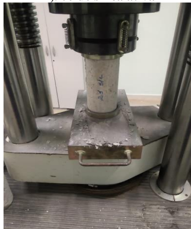
Figura 18 - Ensaio de resistência à compressão axial do concreto com 2,5% de sílica ativa
