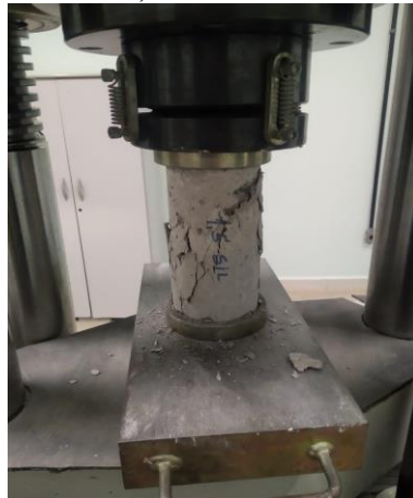
Figura 17 - Ensaio de resistência à compressão axial do concreto com 1,5% de sílica ativa
