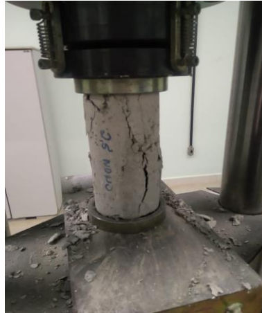
Figura 20 - Ensaio de resistência à compressão axial do concreto com 2,5% de nanossílica
