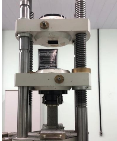
Figura 16 - Ensaio de resistência à compressão axial do concreto referência
