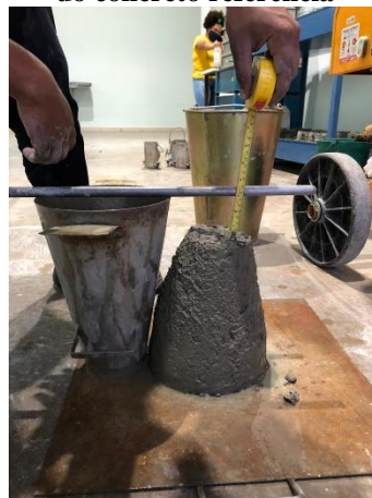
Figura 11- Ensaio de abatimento de tronco de cone do concreto referência
