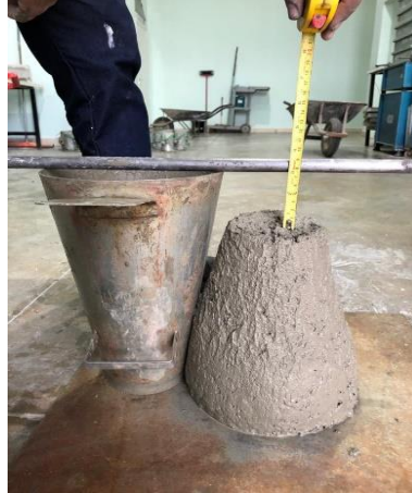
Figura 12 - Ensaio de abatimento de tronco de cone do concreto com 1,5% de sílica ativa
