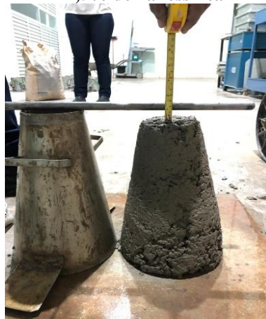
Figura 14 - Ensaio de abatimento de tronco de cone do concreto com 1,5% de nanossílica
