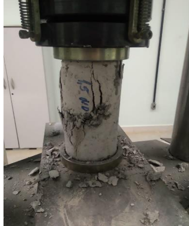
Figura 19 - Ensaio de resistência à compressão axial do concreto com 1,5% de nanossílica
