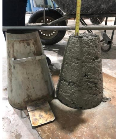
Figura 15 - Ensaio de abatimento de tronco de cone do concreto com 2,5% de nanossílica
