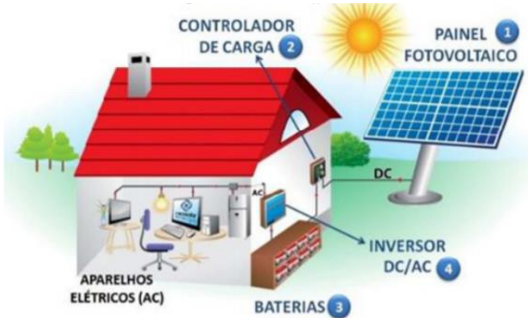
Figura 03 - Sistema de energia fotovoltaica off-grid
