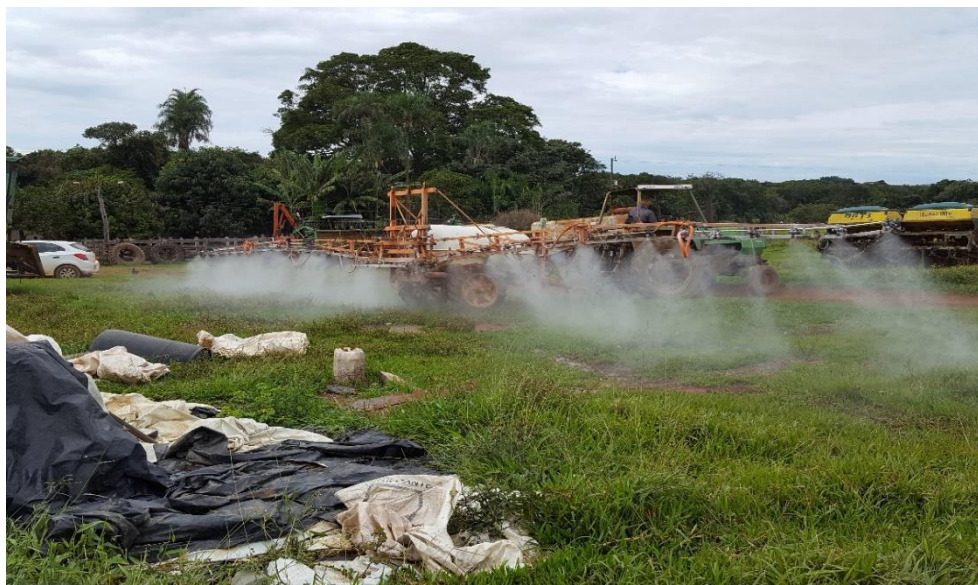
FIGURA 8 - Desuniformidade na vazão do pulverizador hidráulico de arrasto
