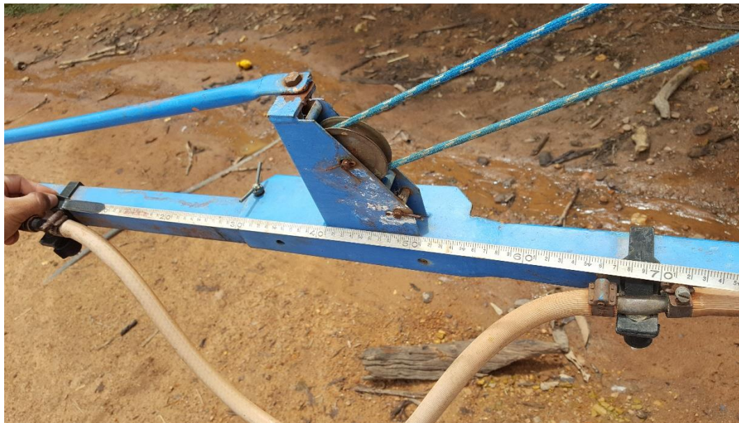
FIGURA 7- Desuniformidade no espaçamento do pulverizador hidráulico acoplado, no qual o espaçamento correto seria de 0,50 m.
