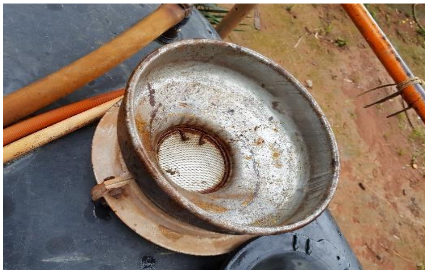
FIGURA 6 – Adaptação realizada no filtro do depósito de um dos pulverizadores inspecionados Fonte: Foto do autor (2019)
