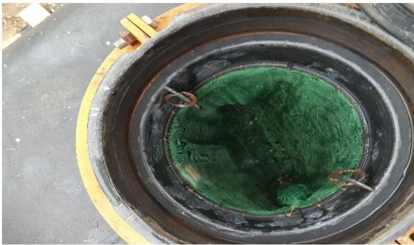
FIGURA 5 – Adaptação realizada no filtro do depósito de um dos pulverizadores inspecionados Fonte: Foto do autor (2019)
