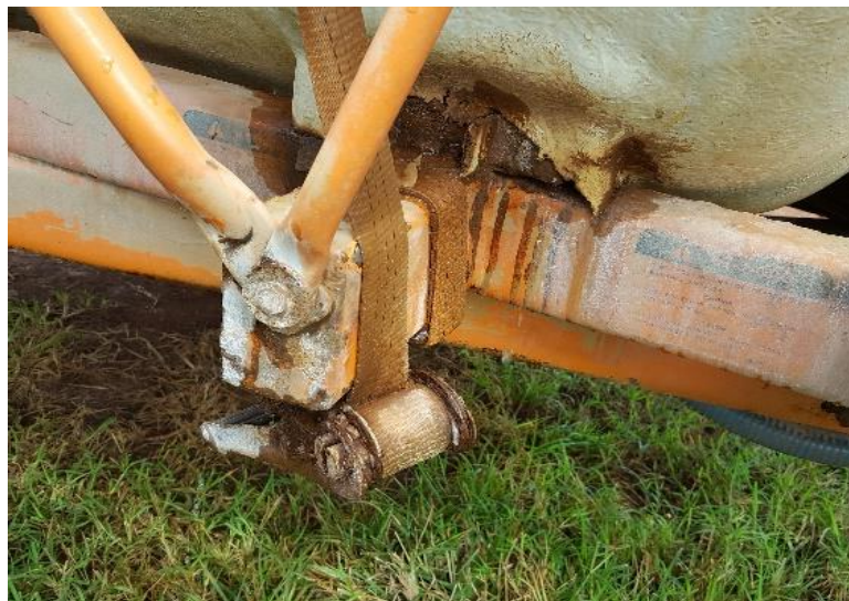
FIGURA 3 – Pulverizador hidráulico de arrasto com vazamento no depósito de calda
