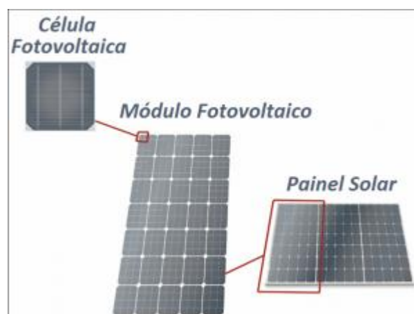
Figura 4: Representação de célula, módulo e painel fotovoltaico.
