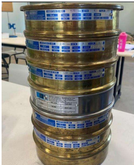
Figura 20 – Peneiras Montadas para Ensaio de Agregado Miúdo.
