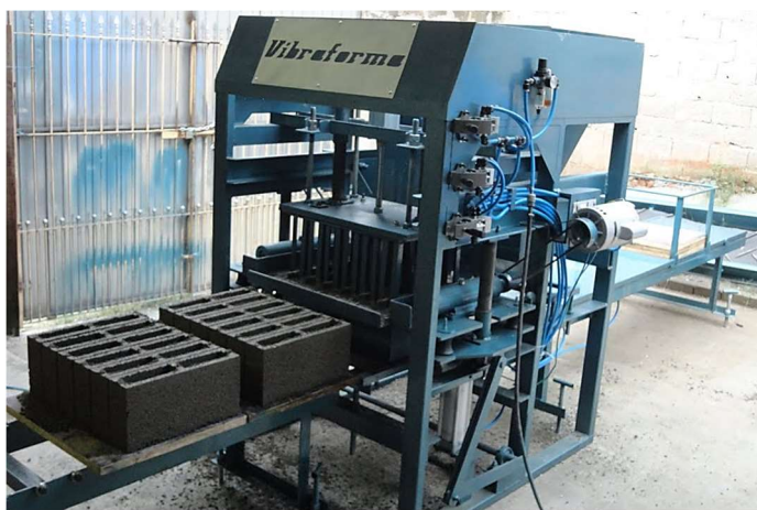
Figura 2 – Máquina Utilizada na Fabricação do Bloco.
