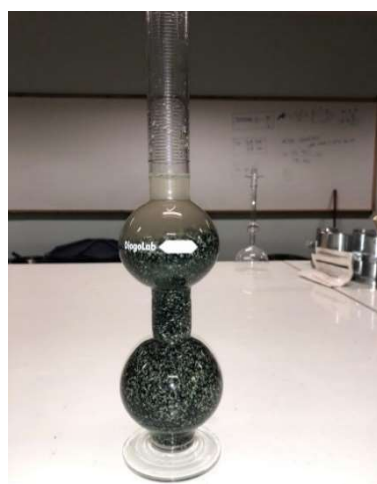
Figura 16 – Frasco Chapman: a) com escória; b) com areia natural
