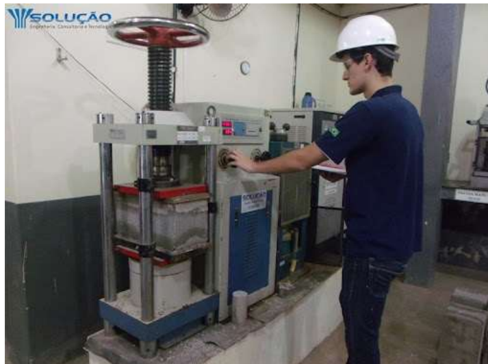
Figura 9 – Teste de Compressão Sendo Realizado.
