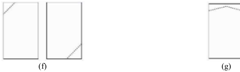
Figura 8.2 – Tipos de Ruptura do Corpo de Prova: f) Tipo F – Fraturas no Topo e/ou na base abaixo do capeamento; g) Tipo G – Similar ao tipo F – com fraturas próximas ao topo.
