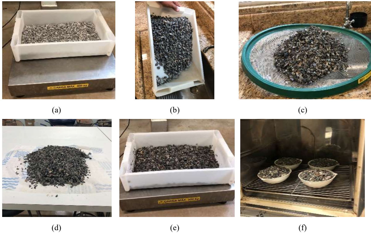
Figura 17 – Ensaio da Massa Específica de Agregado Graúdo: a) Pesagem da amostra; b) Lavagem da brita; c) escoamento da água; d) secagem; e) brita saturada; f) secagem em estufa.
