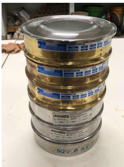
Figura 21 – Peneiras Montadas para Ensaio de Agregado Graúdo.
