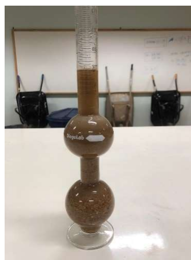
Figura 16 – Frasco Chapman: a) com escória; b) com areia natural
