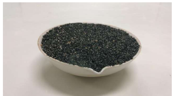
Figura 13 – Agregados Miúdos Utilizados: a) Areia; b) Escória de Ferro níquel.
