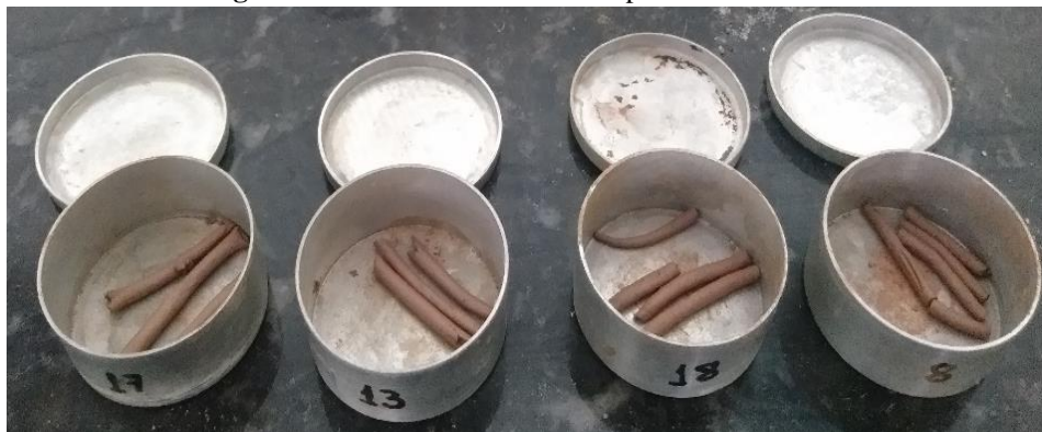
Figura 14 – Amostra de solo em cápsulas de alumínio.
