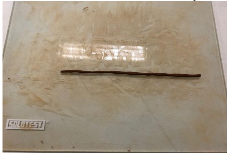
Figura 13 – Solo em formato cilíndrico conformado sobre a placa de vidro.
