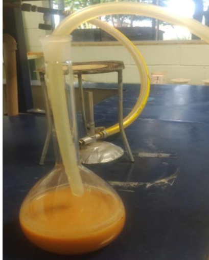
Figura 16 – Aplicação de vácuo ao picnômetro.
