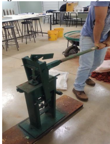
Figura 23 – Prensagem dos tijolos.
