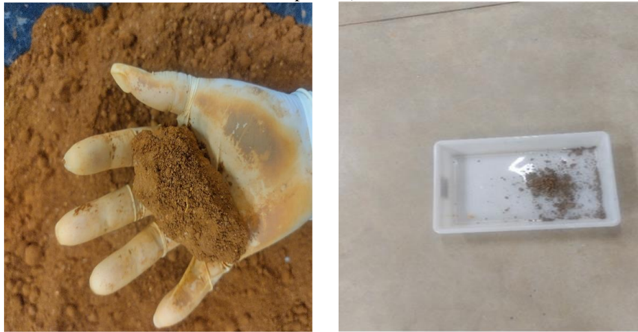
Figura 22 – Teste verificação de umidade: a) Teste 1 (teste do tato) e b) Teste 2 (bolo de mistura solta sobre superfície).
