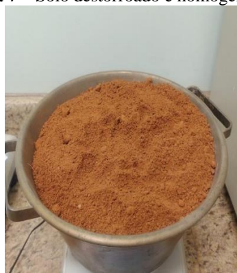
Figura 7 – Solo destorroado e homogeneizado.
