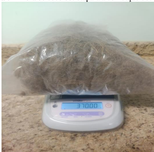
Figura 5 – Fibra de coco obtida para a confecção dos tijolos.
