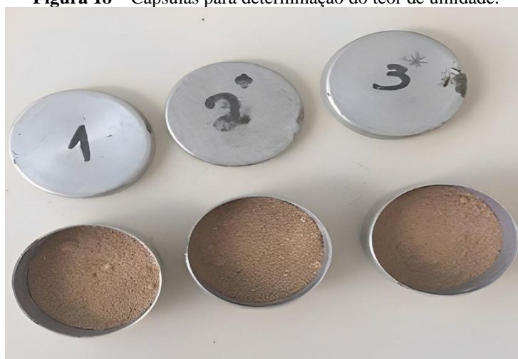
Figura 18 – Cápsulas para determinação do teor de umidade.
