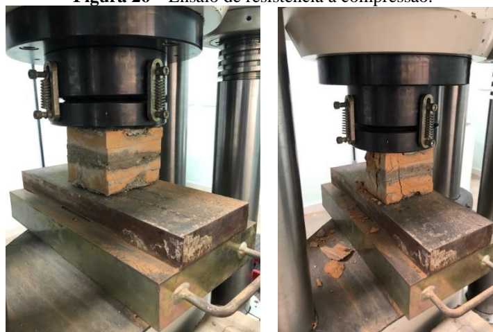
Figura 26 – Ensaio de resistência à compressão.
