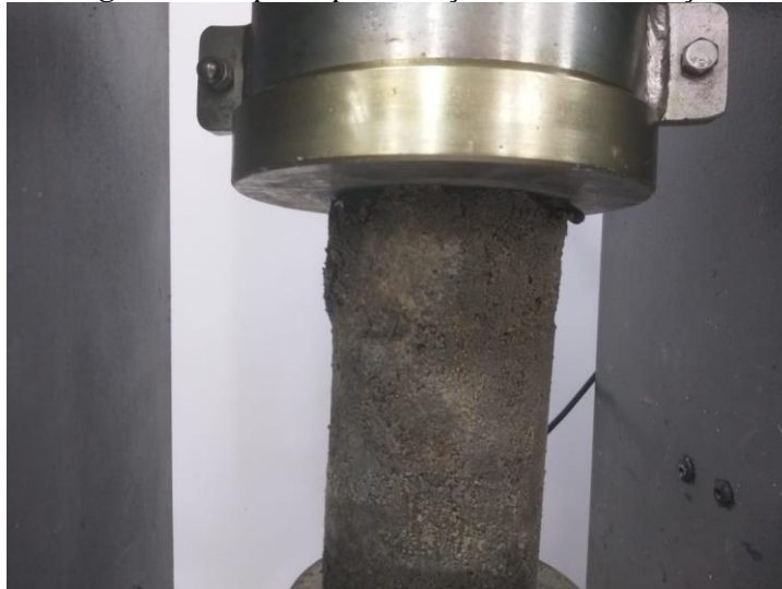
Figura 7- Corpo de prova traço 1% de substituição
