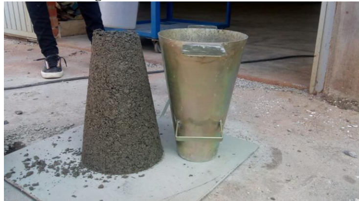
Figura 4- Abatimento do concreto.
