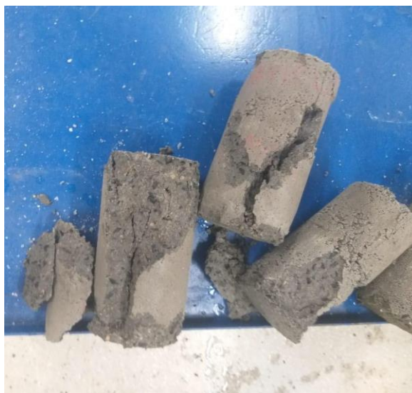
Figura 5- Corpo de prova traço padrão rompido.
