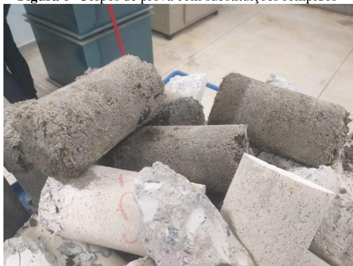
Figura 6- Corpos de prova com substituições rompidos
