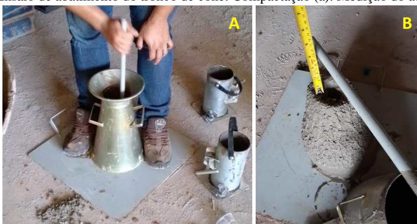
Figura 3 – Ensaio de abatimento do tronco de cone. Compactação (a). Medição do abatimento (b).
