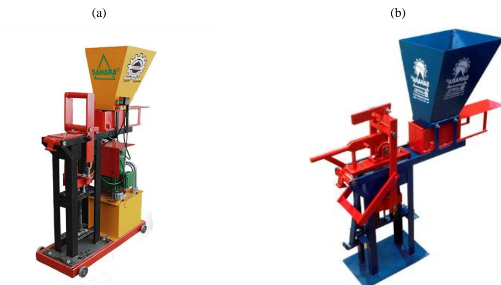
Figura 2.3. (a) Prensa Hidráulica; (b) Prensa Manual.
