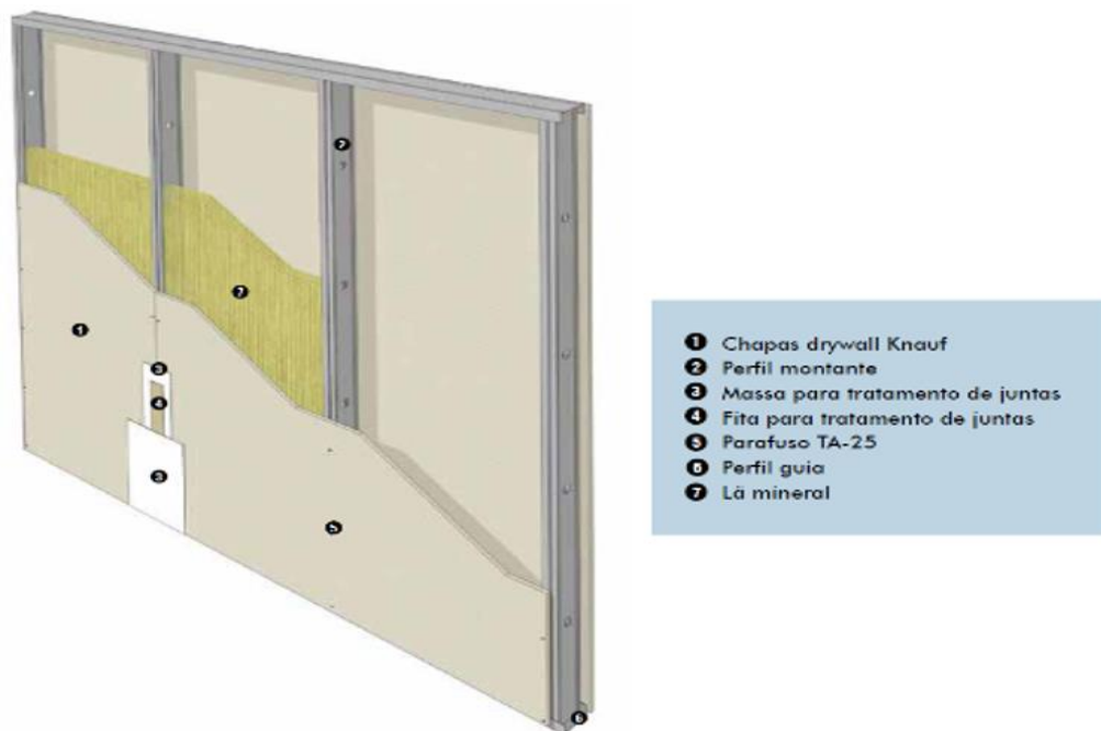
Figura 6- Especificação do drywall.
