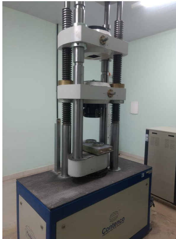
Figura 14 – Prensa mecânica utilizada para a realização dos ensaio de resistência
