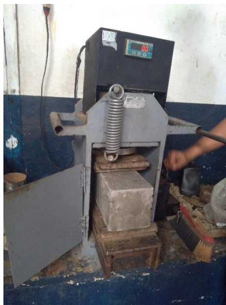
Figura 17 - Prensa manual utilizada para ensaio de resistência à tração na flexão
