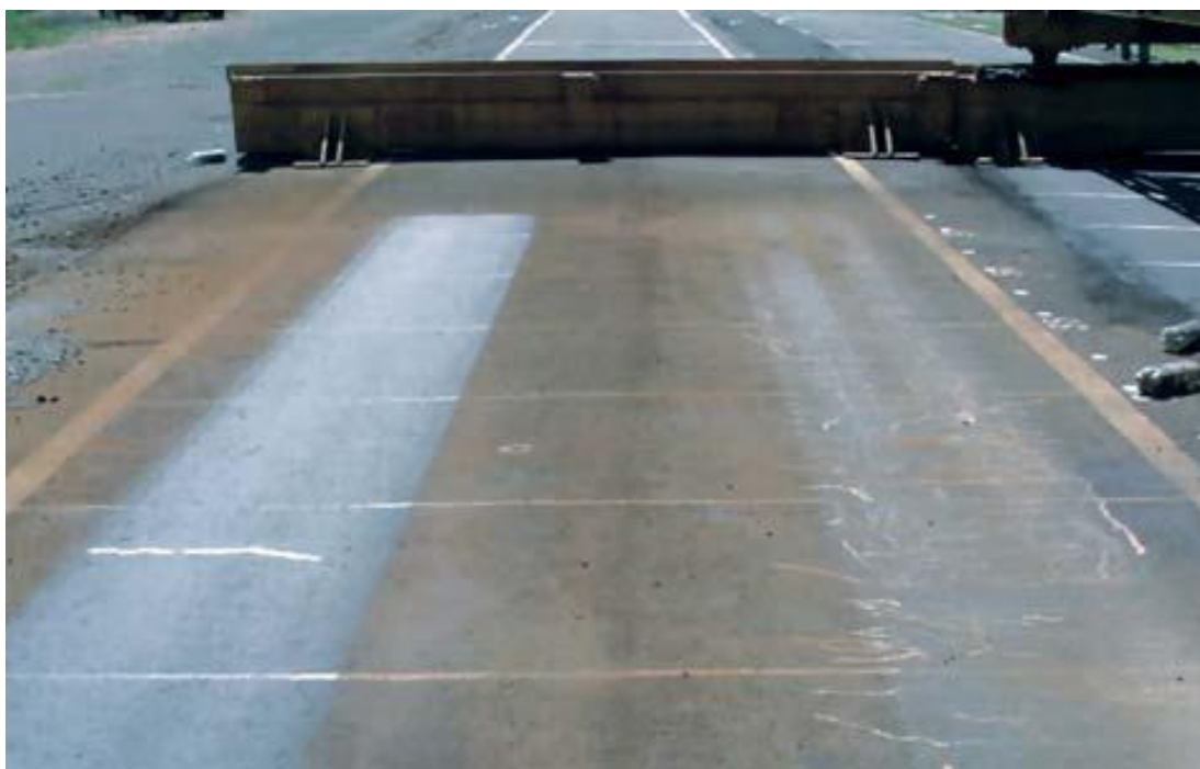
Figura 5 - Simulador de tráfego de asfalto-borracha e asfalto convencional, respectivamente
