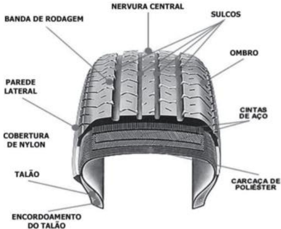
Figura 1: Estrutura de um pneu convencional
