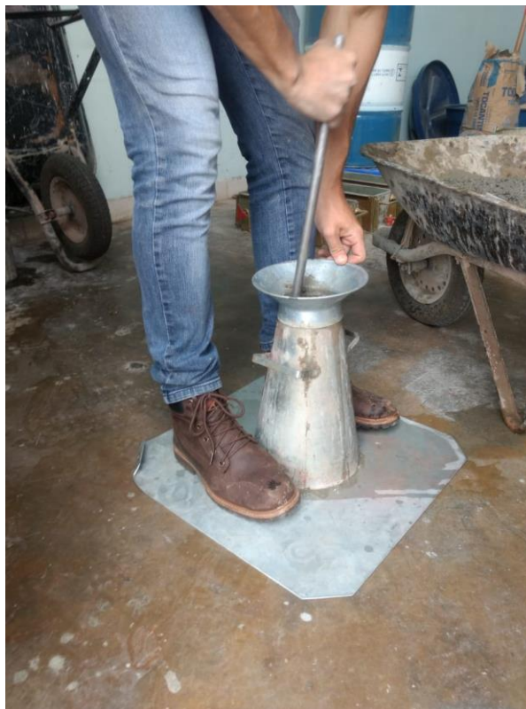
Figura 13- Procedimento para realização do ensaio de abatimento
