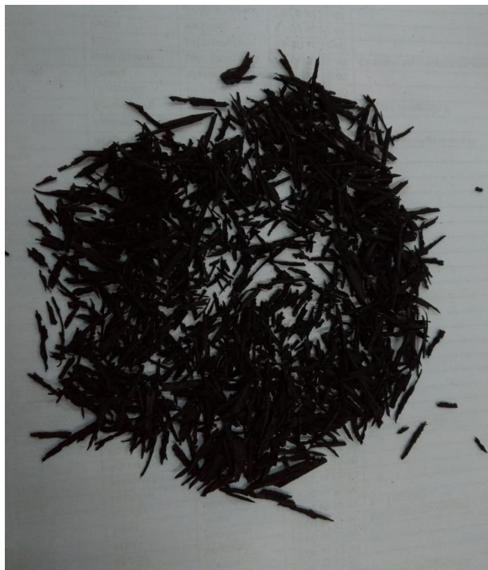
Figura 8 - Figura das fibras de borracha média
