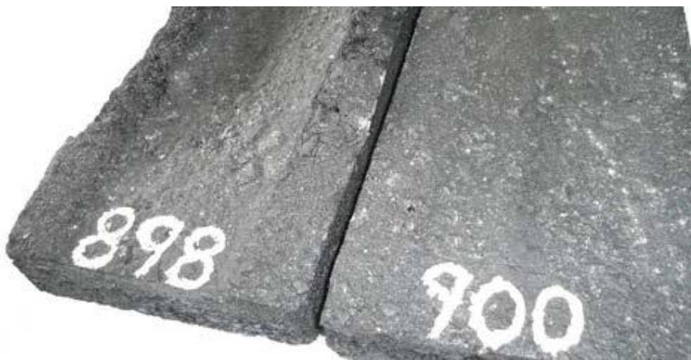
Figura 6 - Simulador de tráfego para verificação de formação de trilha de pneus. Com asfalto convencional e asfalto-borracha, respectivamente.
