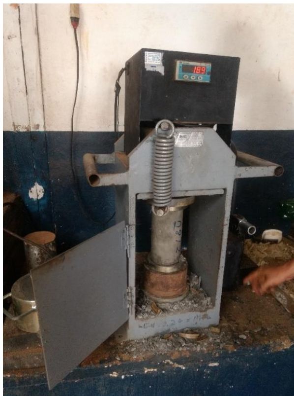
Figura 15 – Prensa manual utilizada para realização do ensaio à compressão axial
