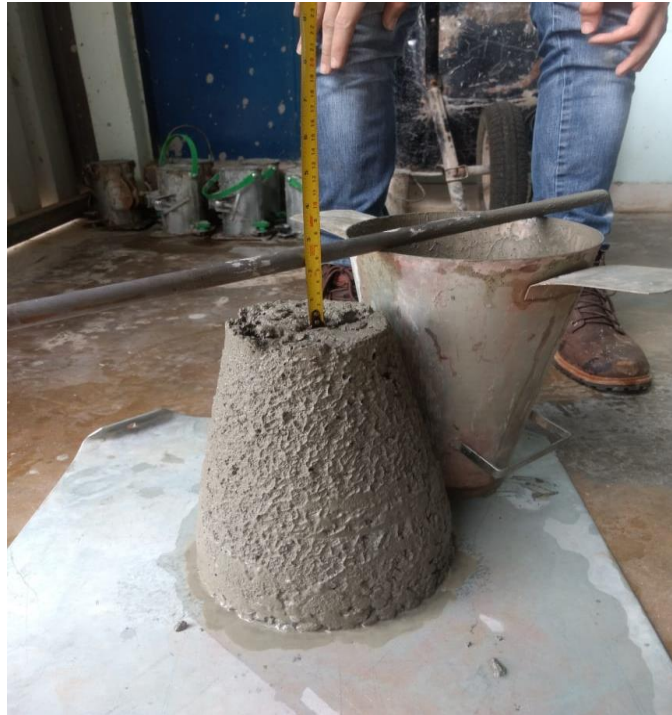
Figura 19 - Traço referencial - Ensaio de Abatimento
