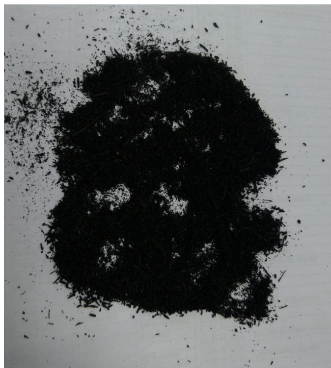
Figura 9 - Figura das fibras de borracha fina
