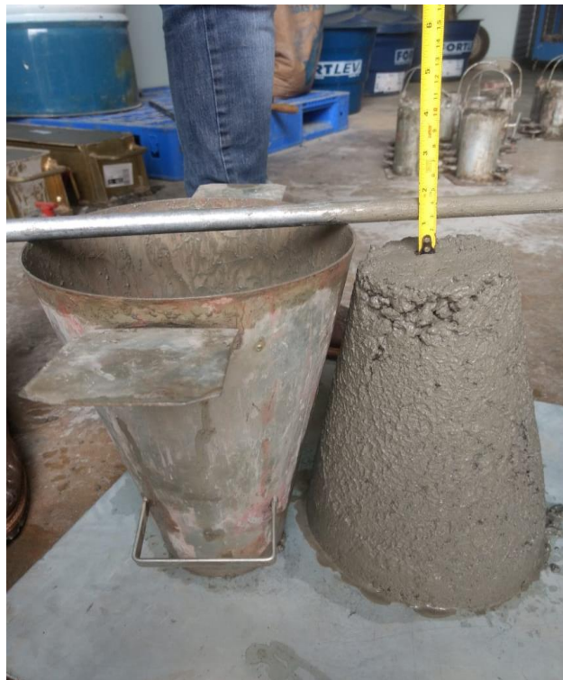
Figura 20 - Borracha fina 5% - Ensaio de Abatimento
