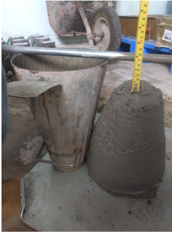
Figura 21 - Borracha fina 10% - Ensaio de Abatimento
