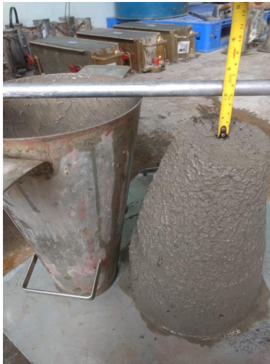
Figura 22 - Borracha média 5% - Ensaio de Abatimento
