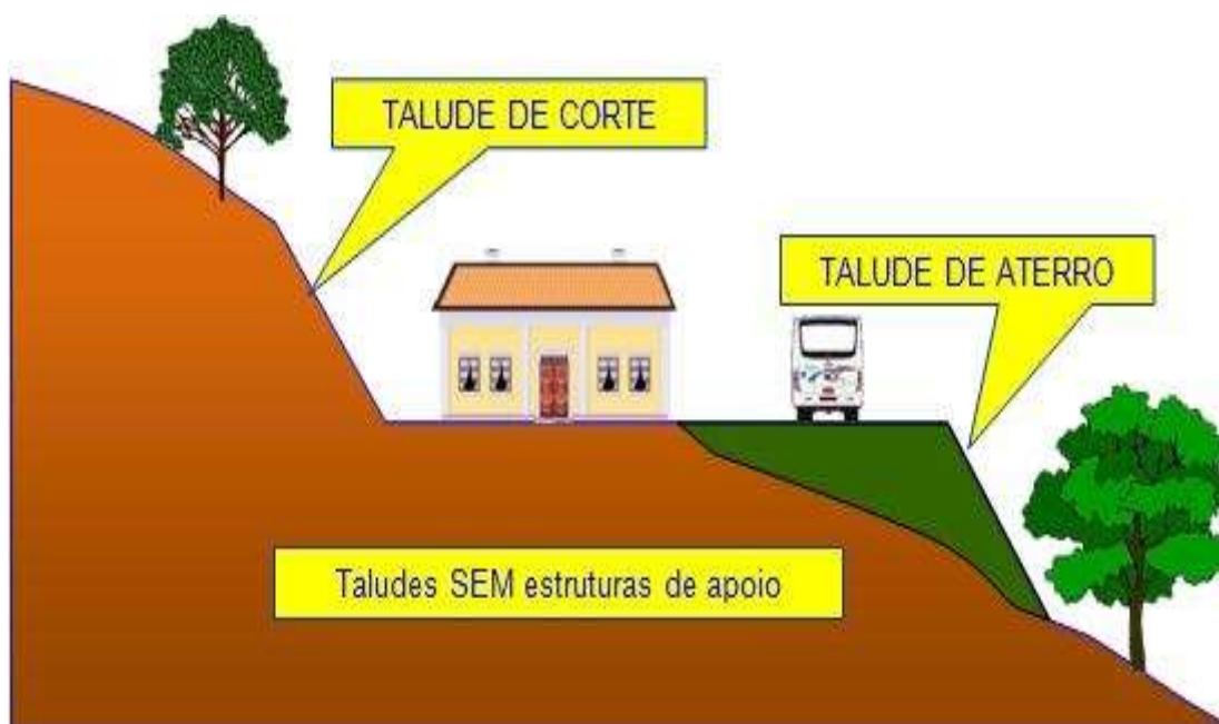
Figura 3 - Modelos de taludes
