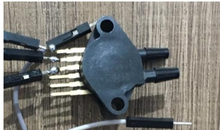
Figura 23: Sensor de pressão diferencial MPX5700DP
