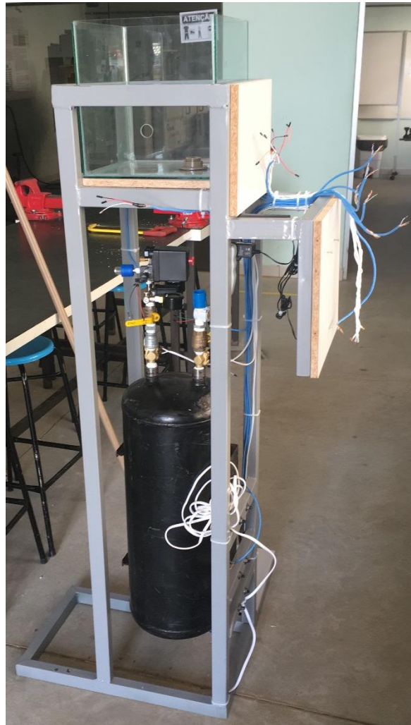
Figura 33: Montagem da parte hidráulica e elétrica
