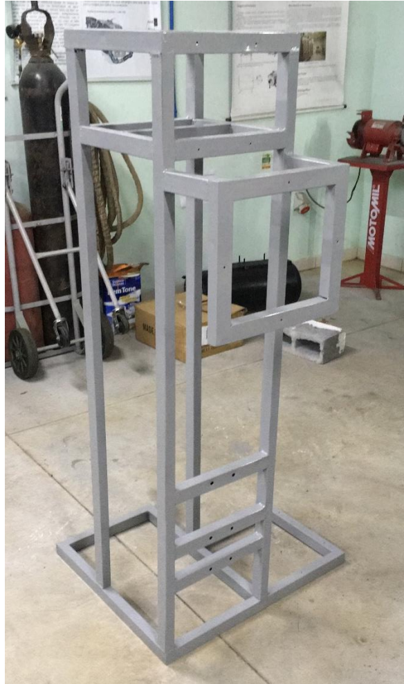
Figura 31: Estrutura de metalon
