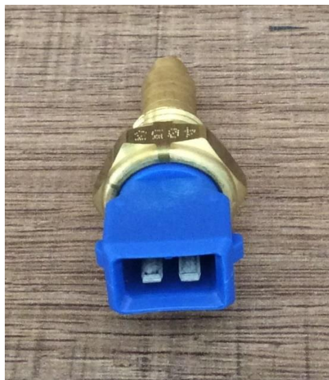
Figura 20: Sensor de temperatura Mte Thomson 4053
