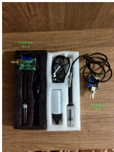
Figura 18: Módulo sensor de Ph V1.1 e V2.0 com sensor de temperatura integrado
