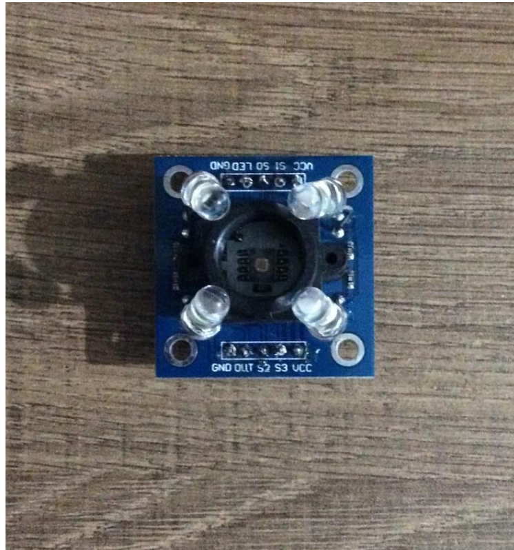
Figura 21: Sensor de reconhecimento de cor TCS230
